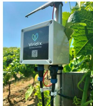
**Mini Estação com sensor de medição do potencial matricial do solo \_ NAAN**
